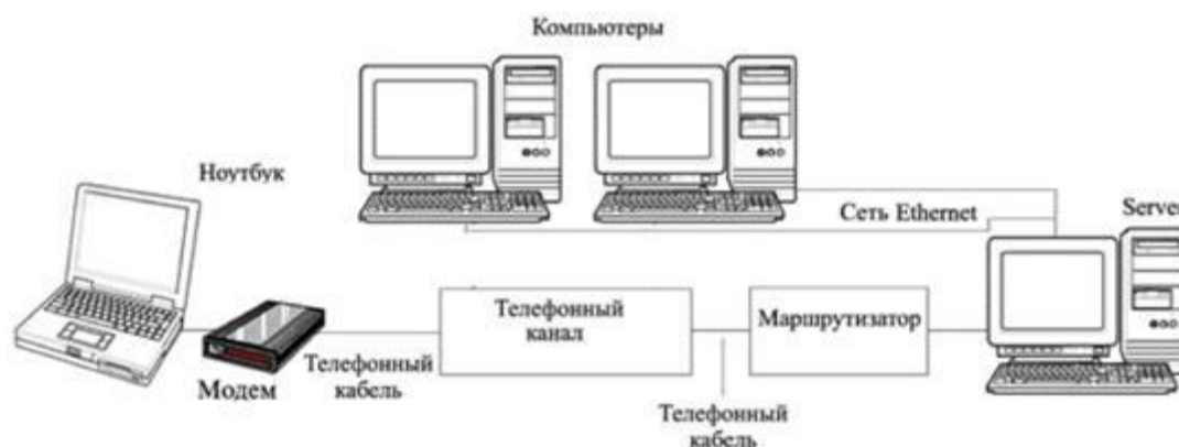
Рис. 5. Вариант связи ПК с удалённой ЛВС с помощью модема.
