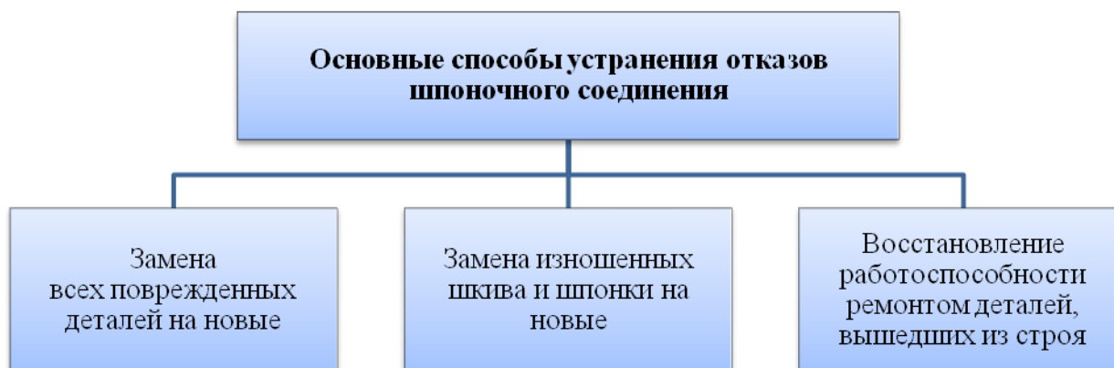
Рис. 10. Основные способы устранения отказов шпоночного соединения
