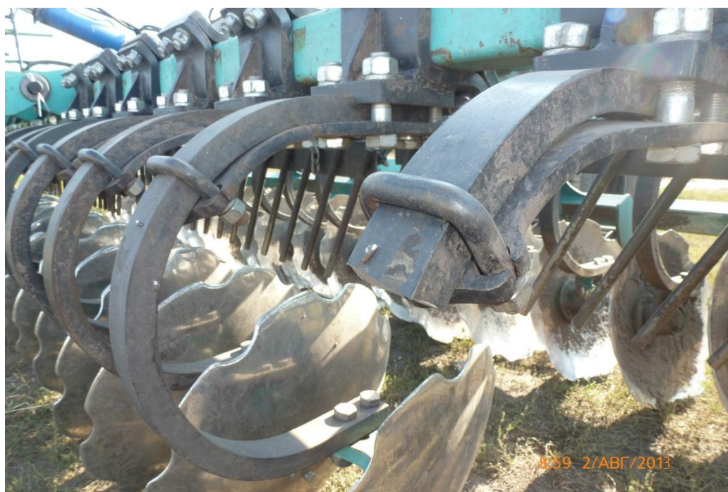
Рис. 17. Разрушение конструкции с дополнительной упругой опорой
