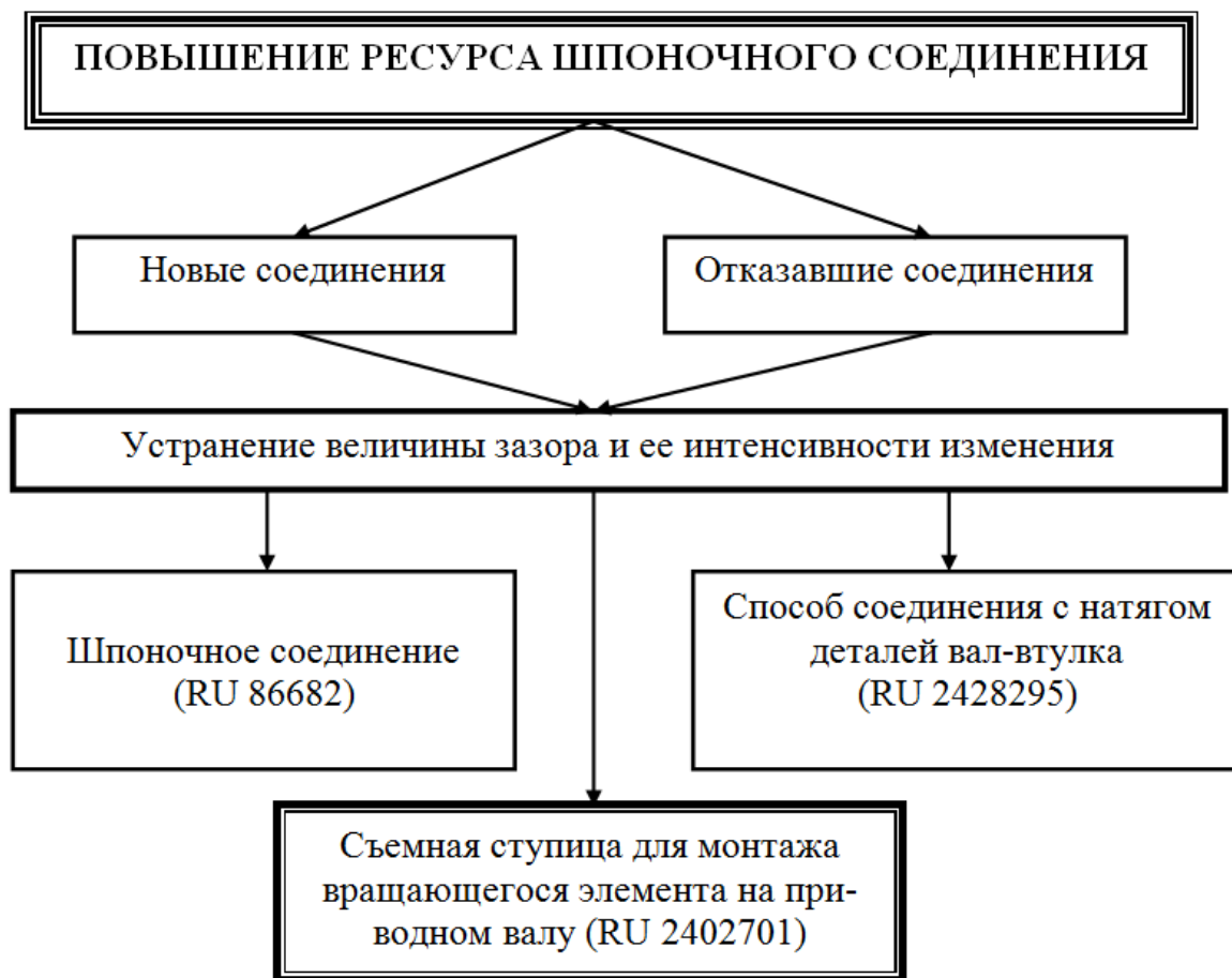
Рис.5. Способы повышения надежности шпоночного соединения
