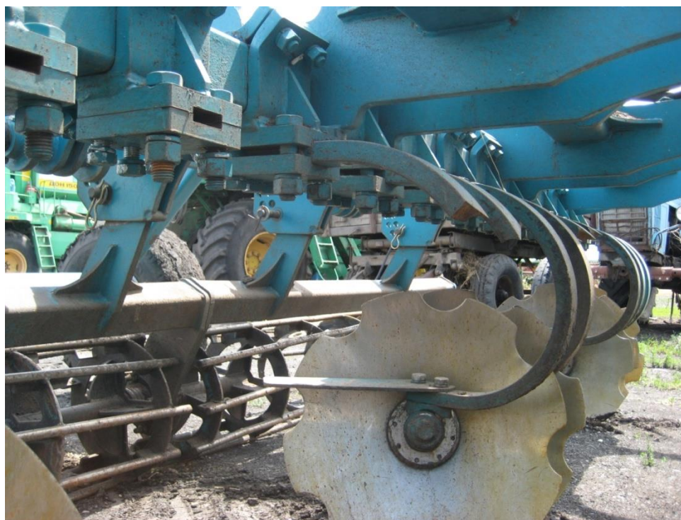
Рис. 1. Разрушение пружинных стоек дисков
