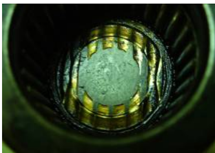
в) следы износа на стакане
