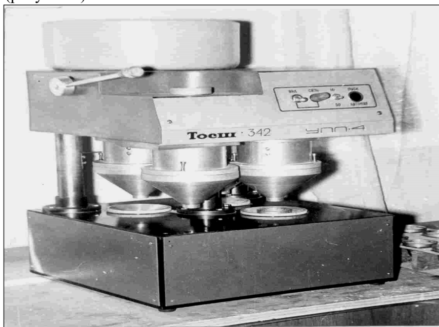
Рис. 8 Общий вид машины УПП-4 для приготовления препаратов при промышленном микроанализе (опытный образец)
