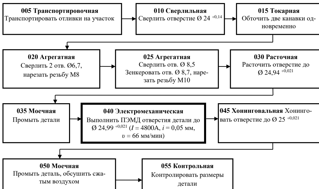
Рис. 7. Схема технологического процесса изготовления колесного цилиндра заднего тормоза автомобиля УАЗ с применением ПЭМД
