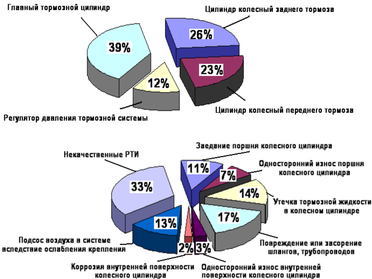
Рис. 1. Неисправности, выявленные в процессе эксплуатации тормозной системы автомобилей УАЗ
