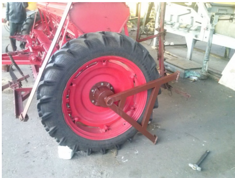
Рис. 9. Сеялка СЗ-5,4 с установленными на нее подставками
