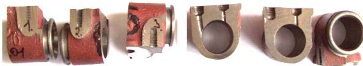
Рис. 3. Экспериментальные образцы колесных цилиндров заднего тормоза автомобиля УАЗ
