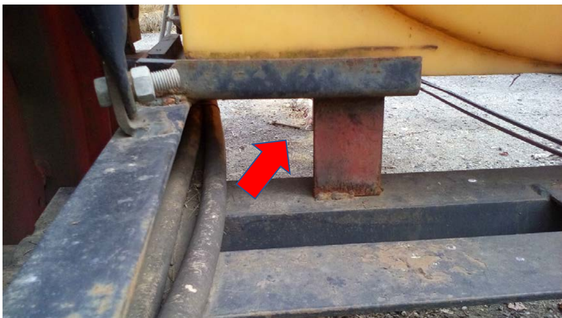
Рис. 11. Установленная левая опорная площадка со стойкой
