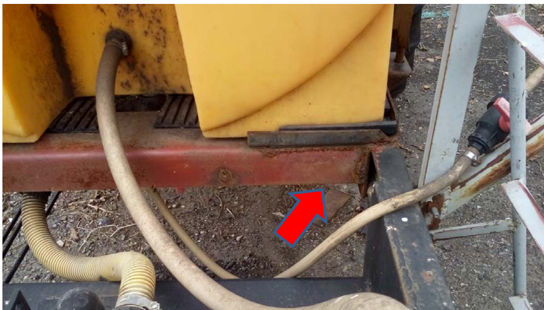
Рис. 10. Установленная дополнительная траверса
