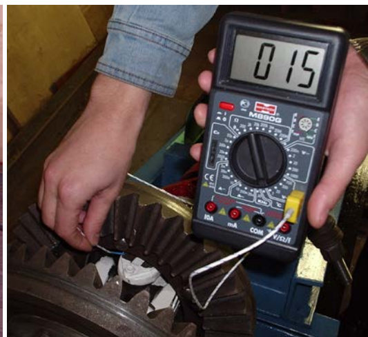
б) измерение температуры подшипниковых узлов
