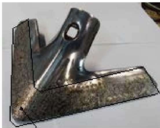
Рис. 2. Стрельчатая лапа после нанесения покрытия до полевых испытаний Зона упрочнения
