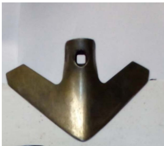
Рис. 1. Стрельчатая лапа до нанесения покрытия (контроль)
