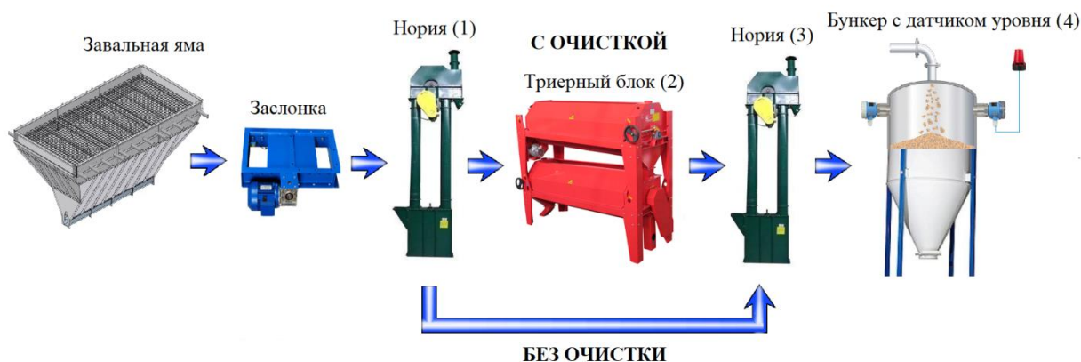
Рис 1 - Порядок технологического процесса линии загрузки зерна.
