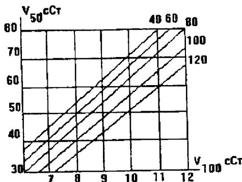
3. Если кинематическая вязкость масла при  $100^{\circ}\text{C}$  равна  $10 \text{ mm}^2/\text{s}$ , а при  $50^{\circ}\text{C}$  –  $50 \text{ mm}^2/\text{s}$ , то в соответствии с nomogrammой индексвязкости масла равен ... (60, 80, 100, 120).
