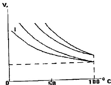
4. На графике с вязкостно-температурными кривыми четырёх масел масло с высоким индексом вязкости соответствует кривой... (I, II, III, IV).
