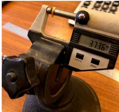
Рис. 3 – Замер зерна на электронном микрометре
