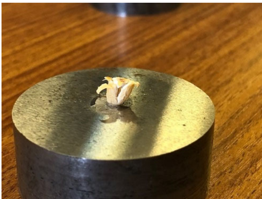
Рис. 7 – Разрушение оболочки с частичным отделением алейронового слоя зерна ячменя
