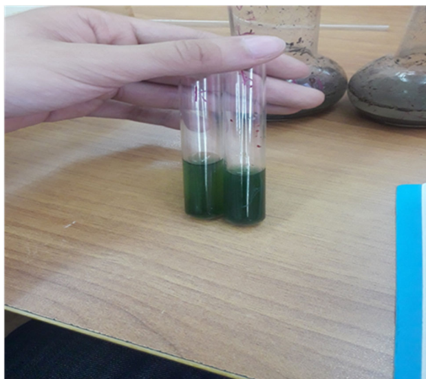
Рис. 2 – Определение кислотности почвенного образца при помощи колориметрического метода
