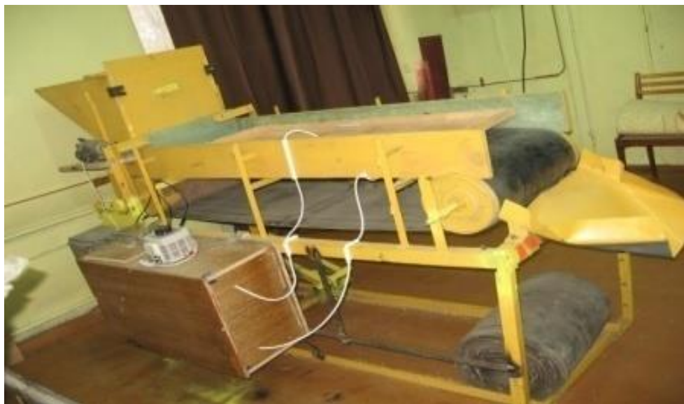
Рисунок 1 - Ленточный электрический многослойный стимулятор семян «ЛЭМС»
