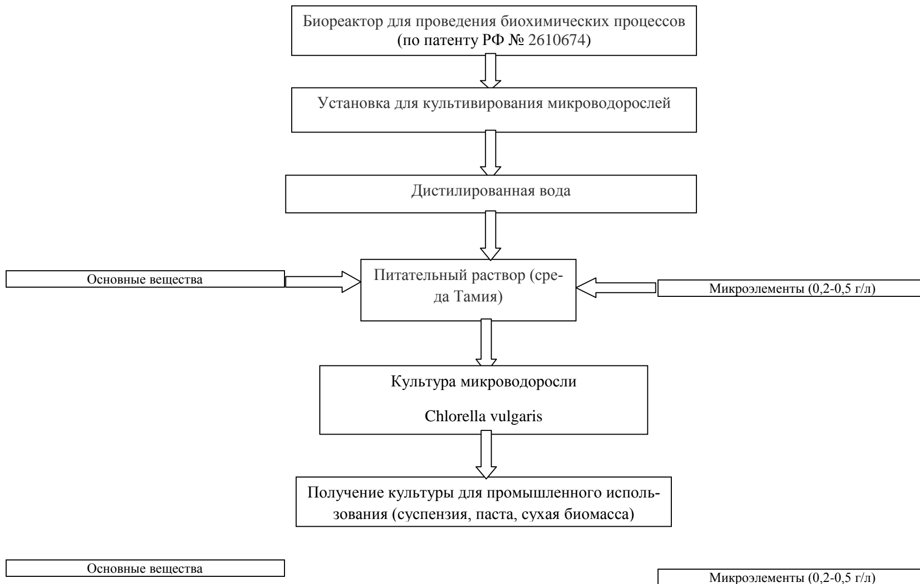
Рисунок 1. Технологическая схема выращивания культуры микроводоросли Chlorella vulgaris с использованием ферментера
