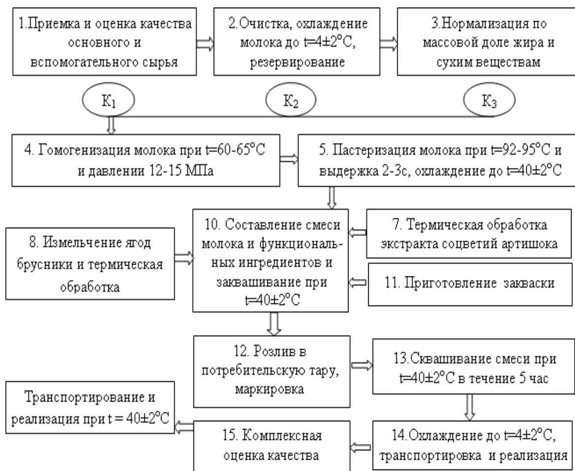
Рисунок 1 – Технологическая схема производства функционального кисломолочного продукта термостатным способом: K 1 – нормализованная смесь м.д.ж. 1,5 %; K 2 – нормализованная смесь м.д.ж. 2,5 %; K 3 – нормализованная смесь м.д.ж. 3,5 %.
