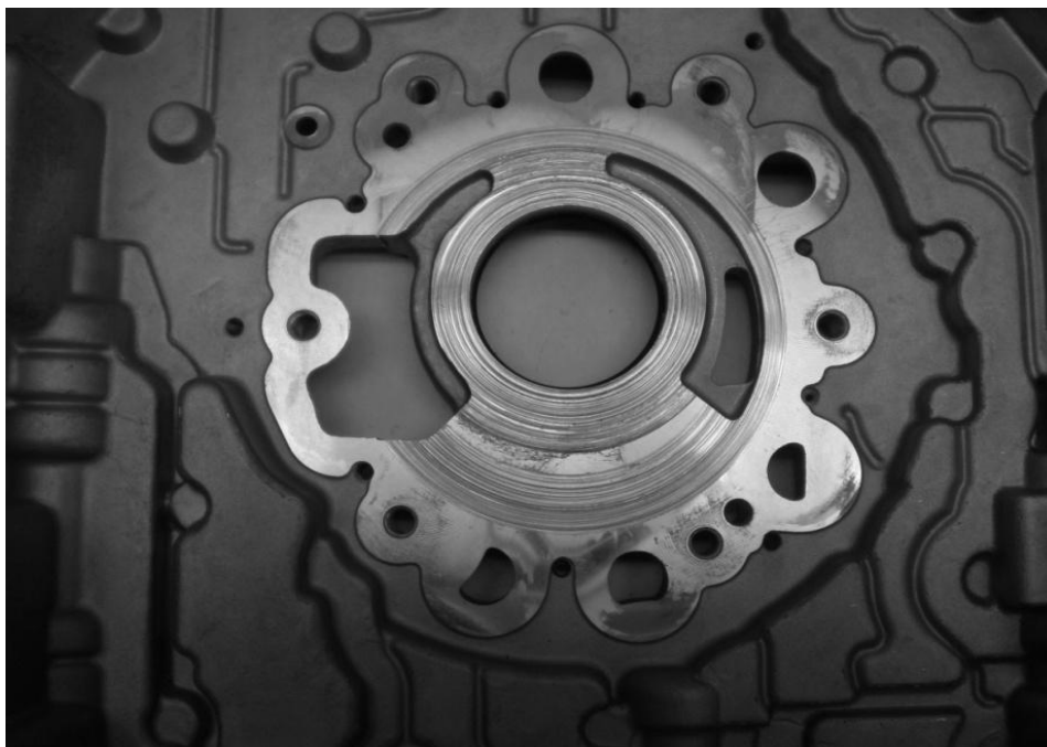
Рис. 5. Дефект рабочей поверхности крышки
