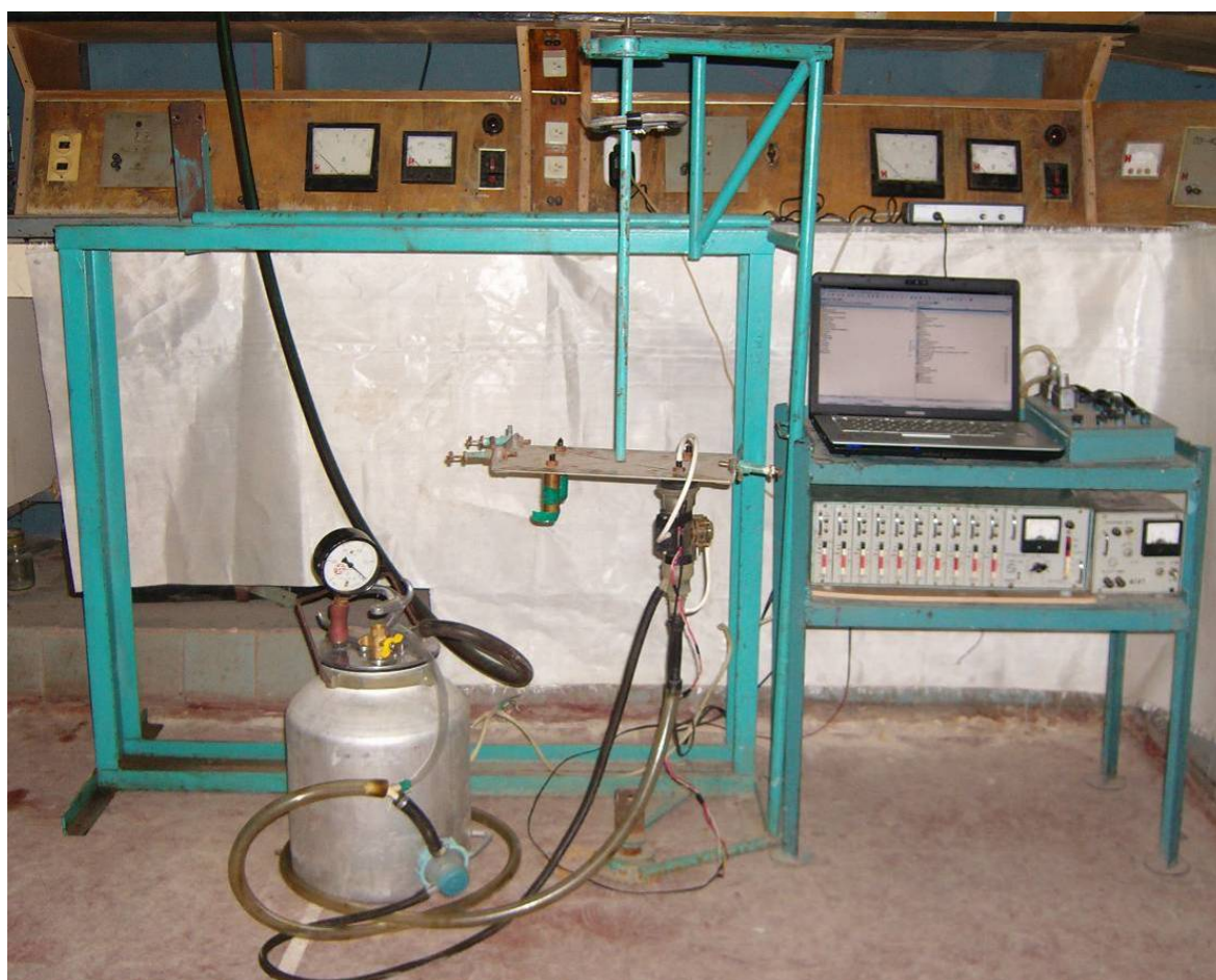
Рис. 1. Лабораторная установка для определения значения вакуумметрического давления в зависимости от диаметра калиброванного отверстия клапанного механизма соскового чулка
