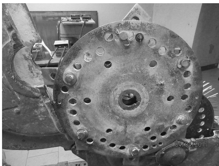
Рис. 2. Общий вид ротора с пластинчатыми молотками решетной молотковой дробилки
