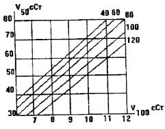
3. Если кинематическая вязкость масла при 100 °c равна 10 мм²\c, а при 50 °C – 50 мм²\c, to в соответствии с номограммой индексвязкости масла равен ... (60, 80, 100, 120).
