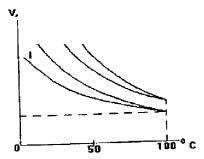
4. На графике с вязкостно-температурными кривыми четырёх масел масло с высоким индексом вязкости соответстствует кривой...(I, II, II, IV).
