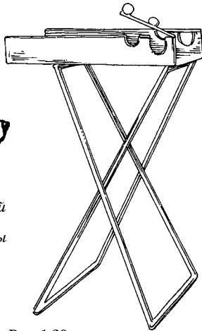
Рис. 1.20 Переносной стол для фиксации индеек и гусей СРФ-1
