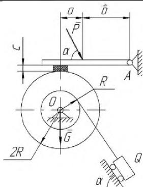
Определить, необходимые для равновесия составной конструкции, минимальное значение силы  $P$  и реакции опор  $A$  и  $O$  конструкции, нагруженной сосредоточенными силами  $Q = 13\text{ кН}$ ,  $G = 1,1\text{ кН}$ , если заданы расстояния  $a = 0,1\text{ м}$ ,  $b = 0,2\text{ м}$ ,  $c = 0,03\text{ м}$  и угол  $\alpha = 45^\circ$ . Коэффициент трения колодки о барабан  $f = 0,25$ . Трением в опорах пренебречь. Веса нитей, стержней и колодок не учитывать.
