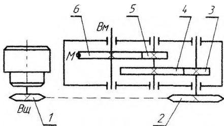
Для схемы привода ковшовой мешалки, состоящей из зубчатых и цепной передач, определить скорость  $V_M$  и ускорение  $a_M$  точки  $M$  ведомого ( $B_m$ ) вала, если известно: угловая скорость  $\omega_1 = 50$  рад/с; угловое ускорение  $\varepsilon_1 = 1$  рад/с<sup>2</sup>; геометрические параметры передач -  $R_1 = 70$  мм;  $R_2 = 160$  мм;  $R_3 = 60$  мм;  $R_4 = 100$  мм;  $R_5 = 70$  мм;  $R_6 = 150$  мм. Задачу решить двумя способами.
