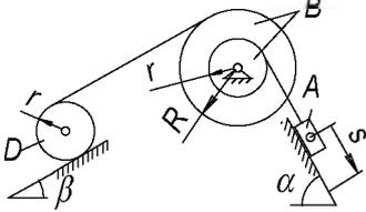
Механическая система под действием сил тяжести приходит в движение из состояния покоя. При движении каток  $D$  испытывает сопротивление качению. Нити считать нерастяжимыми, а их массами пренебречь. Определить ускорение груза  $A$  в момент, когда пройденный им путь станет равным  $S$ .
