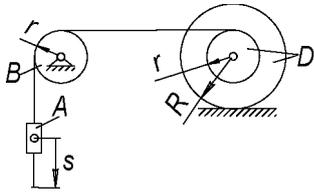
Механическая система под действием сил тяжести приходит в движение из состояния покоя. При движении каток  $D$  испытывает сопротивление качению. Нити считать нерастяжимыми, а их массами пренебречь. Определить ускорение груза  $A$  в момент, когда пройденный им путь станет равным  $S$ .
