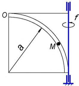
Точка  $M$  движется по трубке радиуса  $a = 20$  см по закону  $OM = 5\pi\sqrt{2} \sin \pi/4t$ , см. Трубка вращается вокруг оси по закону  $\varphi = (3t - t^2)$ , рад, Определить для момента времени  $t_1 = 1$  с абсолютную скорость и абсолютное ускорение точки  $M$ .
