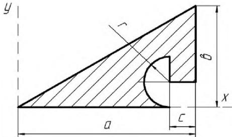
Определить координаты центра тяжести плоской фигуры из тонкой однородной пластины, если известны ее размеры  $a=18$  см,  $b=22$  см,  $c=4$  см и  $r=5$  см.
