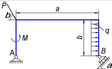
Определить реакции опор  $A$  и  $B$  конструкции, нагруженной сосредоточенной силой  $P = 12$  Н, моментом  $M = 6$  Н·м и распределенной нагрузкой  $q = 3$  Н/м, если заданы расстояния  $a = 0,4$  м,  $b = 0,2$  м, и углы  $\alpha = 45^\circ$ ,  $\beta = 60^\circ$ .
