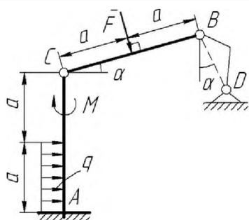
Определить реакции жесткой заделки  $A$  и невесомого стержня  $BD$  составной конструкции, нагруженной сосредоточенной силой  $F = 20\text{ Н}$ , моментом  $M = 10\text{ Н·м}$  и распределенной нагрузкой  $q = 2\text{ Н/м}$ , если заданы расстояние  $a = 0,3\text{ м}$  и угол  $\alpha = 45^\circ$ .
