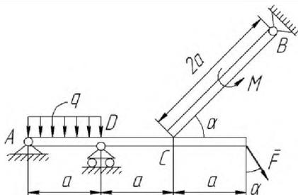
Определить реакции опор  $A$ ,  $B$ ,  $D$  и упора  $C$  составной конструкции, нагруженной сосредоточенной силой  $F = 12\text{ Н}$ , моментом  $M = 6\text{ Н·м}$  и распределенной нагрузкой  $q = 3\text{ Н/м}$ , если заданы расстояние  $a = 0,2\text{ м}$ , и угол  $\alpha = 60^\circ$ .
