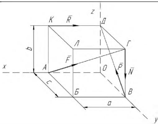
Определить главный вектор и главный момент системы сил  $F=10$  кН,  $P=5$  кН,  $R=25$  кН,  $N=20$  кН, приложенных к параллелепипеду со сторонами  $a=50$  см,  $b=50$  см,  $c=50$  см. Установить также к какому простейшему виду приводится данная система сил.
