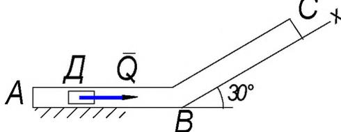
Тело  $D$  массой  $m=4$  кг движется в трубе  $ABC$ , расположенной в вертикальной плоскости. В положении  $A$  телу сообщили начальную скорость  $V_A=2$  м/с. В положении  $B$  тело, не изменяя своей скорости, переходит на участок  $BC$ . Движение тела происходит под действием сил: а) на участке  $AB$  –
