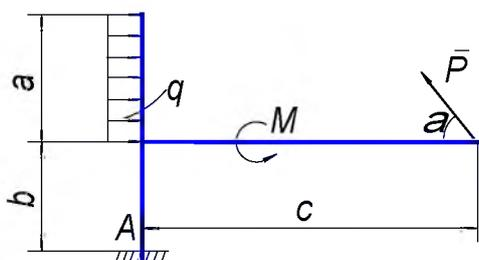
Определить реакции жесткой заделки  $A$  конструкции, нагруженной сосредоточенной силой  $P=8 \text{ Н}$ , моментом  $M=18 \text{ Н·м}$  и распределенной нагрузкой  $q=6 \text{ Н/м}$ , если заданы расстояния  $a=0,3 \text{ м}$ ,  $b=0,2 \text{ м}$ ,  $c=0,4 \text{ м}$  и угол  $\alpha=45^\circ$ .
