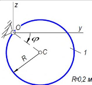
Механическая система, состоящая из однородного диска, вращается вокруг неподвижной оси. Определить реакции шарнира  $O$  в момент времени, когда угол поворота  $\varphi = \varphi_1 = 90^\circ$  если известны:  $m_1 = 40 \text{ кг}$  – масса диска 1;  $\omega_0 = 1 \text{ с}^{-1}$  – угловая скорость в начальный момент времени;  $\varphi_0 = 30^\circ$  – угол поворота в начальный момент времени. Толщиной диска пренебречь. Плоскость  $Oyz$  вертикальная.
