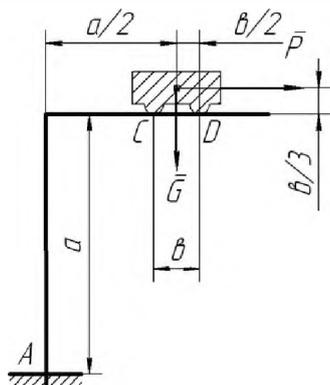
Определить, необходимые для равновесия составной конструкции, максимальное значение силы  $P$ , реакции жесткой заделки  $A$  и упоров  $C$  и  $D$  конструкции, нагруженной сосредоточенной силой  $G=2 \text{ кН}$ , если заданы расстояния  $a=5 \text{ м}$  и  $b=1,4 \text{ м}$ . Коэффициент трения упоров  $C$  и  $D$  о брус  $f=0,4$ .
