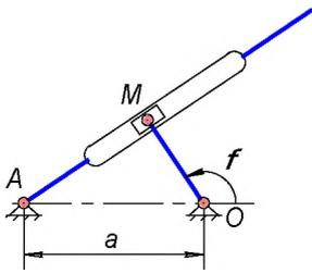
Кривошип  $OM$  вращаясь вокруг неподвижной опоры  $O$  по закону  $\varphi = 2\pi t^2$ , рад, приводит в движение ползун  $M$  по кулисе  $A$ . Определить для момента времени  $t_1 = 1/2$  с абсолютную скорость и абсолютное ускорение точки  $M$ , если известны расстояния  $OM = 14$  см,  $a = 40$  см.
