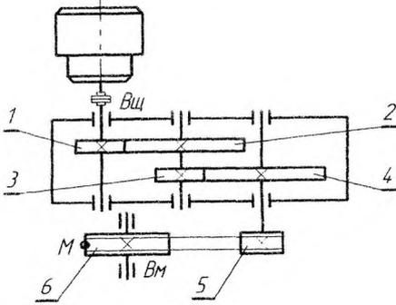
Для схемы привода ленточного транспортера, состоящей из зубчатых и клиноременной передач, определить скорость  $V_M$  и ускорение  $a_M$  точки  $M$  ведомого ( $B_m$ ) вала, если известно: угловая скорость  $\omega_1 = 100$  рад/с; угловое ускорение  $\varepsilon_1 = 1$  рад/с<sup>2</sup>; геометрические параметры передач -  $R_1 = 50$  мм;  $R_2 = 150$  мм;  $R_3 = 60$  мм;  $R_4 = 120$  мм;  $R_5 = 60$  мм;  $R_6 = 120$  мм. Задачу решить двумя способами.
