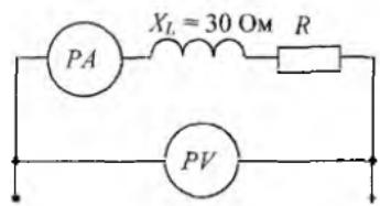
48. Если напряжение  $U_3 = 10 \text{ В}$ , то напряжение  $U$  на входе цепи равно?
