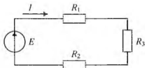
37. В цепи известны сопротивления  $R_1 = 10 \text{ Ом}$ ,  $R_2 = 20 \text{ Ом}$ , напряжение  $U = 100 \text{ В}$  и мощность  $P = 200 \text{ Вт}$  всей цепи. Мощность  $P_2$  второго резистора будет равна:
